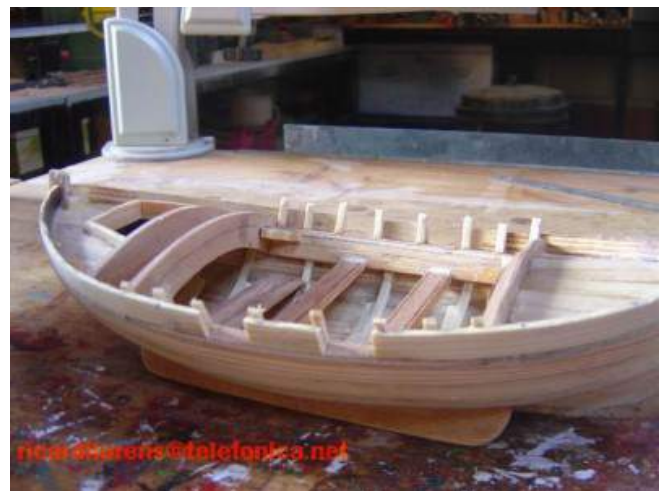
Colocamos los barranetes
