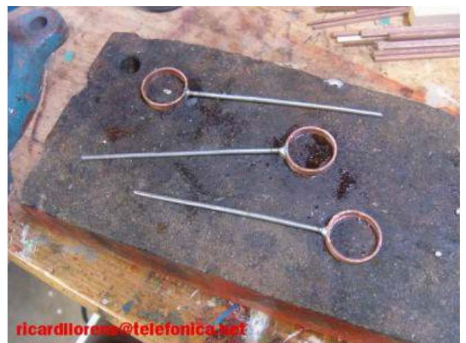
A los aros de sujeción de las luces le hemos soldado los brazos que también irán soldados al árbol principal
