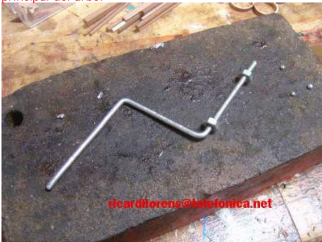
A los aros de sujeción de las luces le hemos soldado los brazos que también irán soldados al árbol principal
