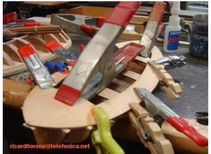
Cubierta encolada con cola blanca y pinzas
