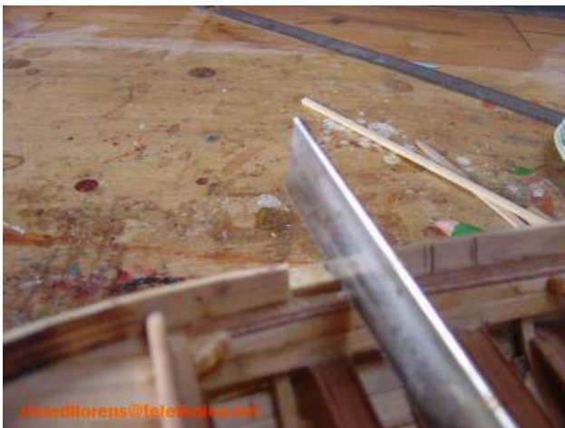
Con la sierra xac-to abrimos donde iran los remos
