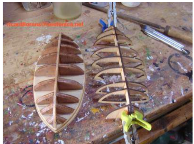
Aquí podemos ver el molde y las cuadernas del kit montadas
